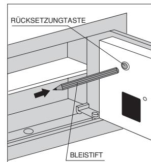
*Wenn nach dem Drücken der Taste der Speichervorgang erfolgreich abgeschlossen worden ist, schalten sich die beiden Led aus , außerdem ist ein kurzes Akustiksignal zu hören .* Wenn der Speichervorgang nicht erfolgreich abgeschlossen werden konnte , schalten sich die beiden Led aus und es ist ein langes Akustiksignal zu hören .
