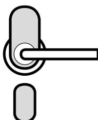
**A3** per porte con telaio tubolare con rondelle ovali (foro 50 mm) – larghezza profilo min. 65 mm
